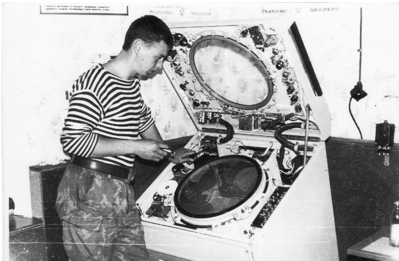
Foto 39. Atla tehnilise vaatluse post. Operaatorihoone [7] sisevaade (radari „Najada” indikaatoriseade). Allikas: Андрей Фокин, teenistusaeg 1987-1989 sügis (pogran-zastava.ru).
