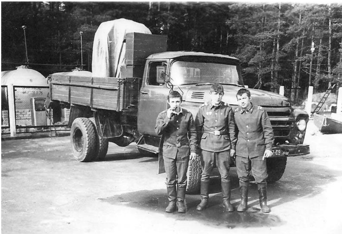
Foto 71. (apm90.jpg) Hullo piirivalvekordon. Prožektorijaam APM-90 ZiL-130 baasil, selle taga tankla asukoht tsisternidega [9]. Paremäl pildiservas dott SPS-2 [10]. Allikas: http://vormsi-17.narod.ru Фотоальбом Игоря (teenistusaeg 1987 - 1989)
