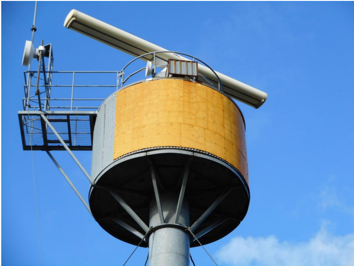
Foto 29. (335) Paljassaare vana tehnilise vaatluse post. Veeteede Ameti laevaliiklusradar EE60931D [25]. Foto Jüri Pärn 16.10.2016.
