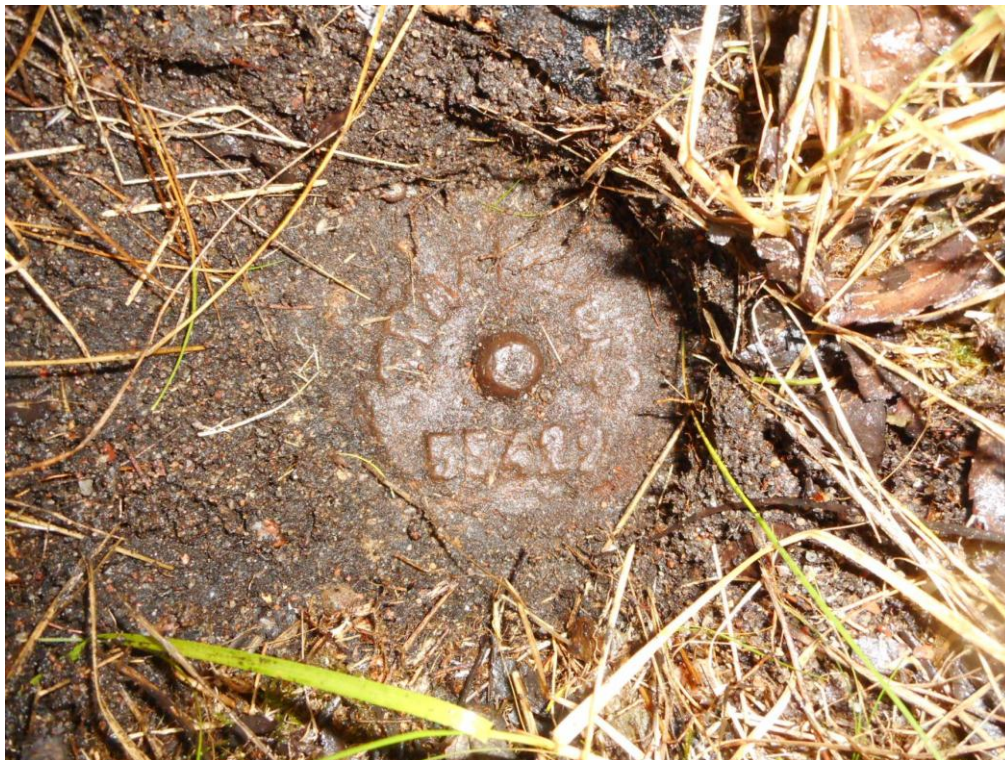
Foto 25. (354) Neeme tehnilise vaatluse post. Triangulatsioonipunkti [11] nr 55422 tsepter on paigaldatud NL Kaitseministeeriumi (või selle eelkäijate) Sõjatopograafiateenistuse poolt (tseptril on kiri „ТРИАНГ. BTC”). 1,5 m sügavusel maa sees peaks olema dubleeriv tsepter. Objekt on kandnud EV geodeetiliste punktide andmebaasi, kuid ilma tseptri numbrita. Foto Jüri Pärn 8.12.2016.
